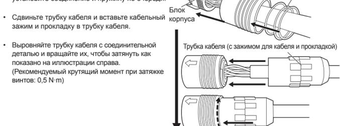
• Сдвиньте трубку кабеля и вставьте кабельный зажим и прокладку в трубку кабеля.
