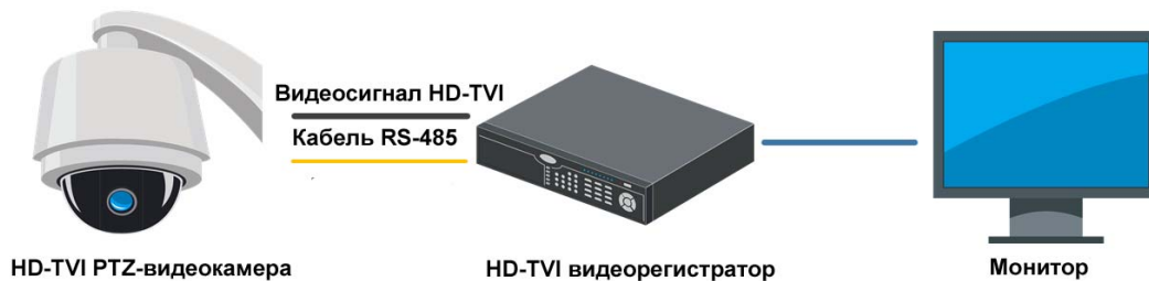
Рис. 2.3. Типичная схема управления через видеорегистратор
