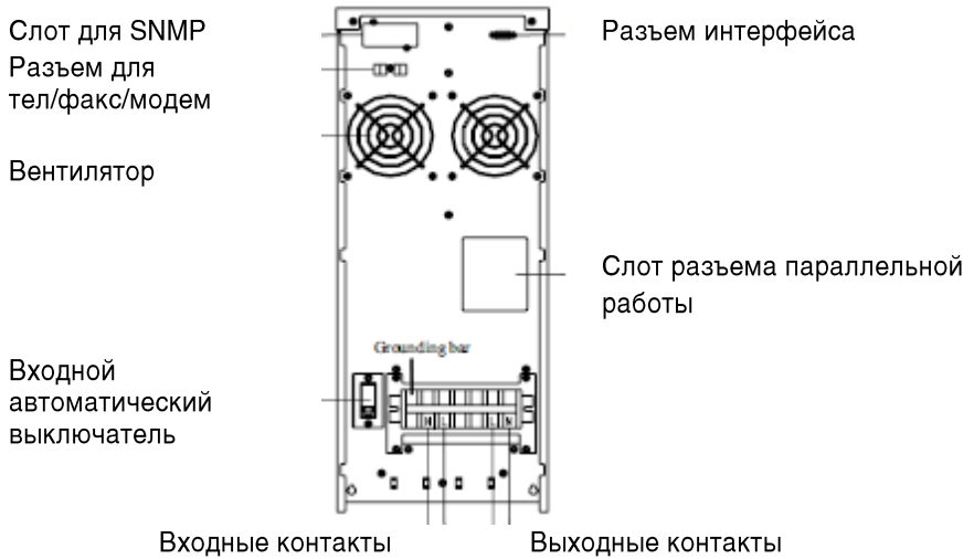
Рисунок 4. Задняя панель для 6 кВА и 10 кВА LCDS
